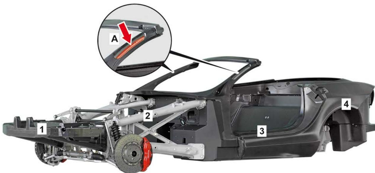
A ピラー補強材 (A) を備えた SLR McLaren Roadster (モデル 199) の車両構造
